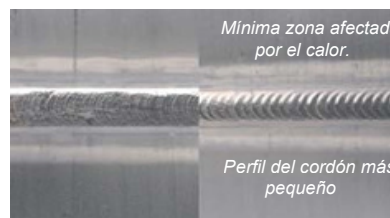
Soldadura con TIG estándar (a 60 amps) Soldadura con TIG pulsado (a 60 amps)
