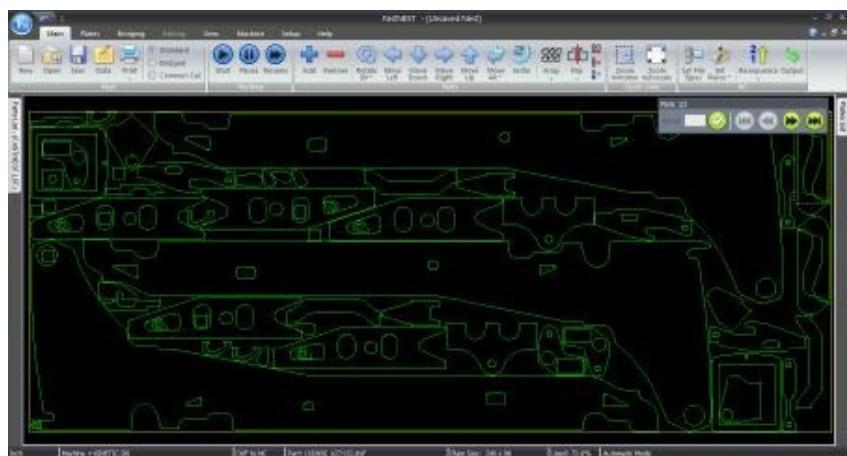
El pathing, la jerarquización verdadera de la forma, la verificación del código y la generación del NC hacen de este software la solución más completa a bajo costo para el corte de perfiles. Incluso en trabajos de construcción grandes y complejos, donde se usan placas pesadas, el software FastCAM funciona perfectamente.
