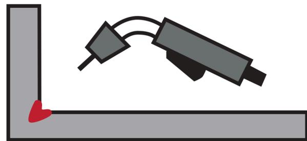
**Voltaje** - El voltaje del arco afecta la longitud del arco. A la misma velocidad de alimentación del alambre, a medida que aumenta el voltaje, la longitud del arco se alarga y a medida que el voltaje disminuye, la longitud del arco se acorta. La longitud del arco determina a su vez la anchura y el tamaño del cono del arco. Observe los cambios en el charco de soldadura en la imagen que se muestra arriba.
