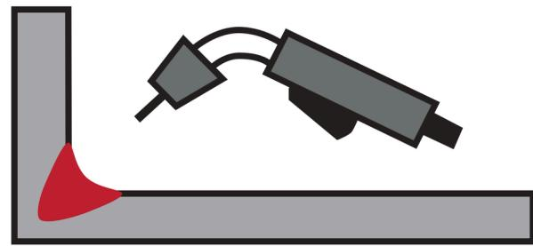
**Velocidad de alimentación del alambre** - A medida que aumenta la velocidad de alimentación del alambre, aumenta la penetración de la soldadura y, a medida que disminuye la velocidad de alimentación del alambre, disminuye la penetración de la soldadura. Observe los cambios en el charco de soldadura en la imagen que se muestra arriba.
