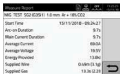
Reporte de parámetros de soldadura
