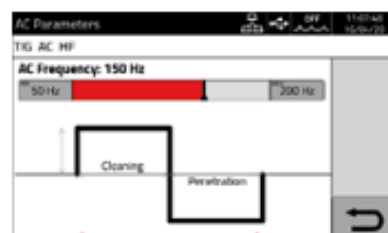
Control de frecuencia de corriente alterna para AC-DC TIG.
